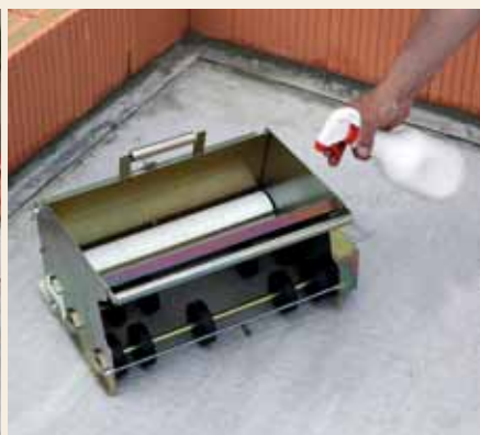
5. Die Mörtelrolle vor der ersten Befüllung dünn mit Trennmittel einsprühen. Das verhindert das Anhaften von Mörtel und erleichtert die spätere Reinigung.
