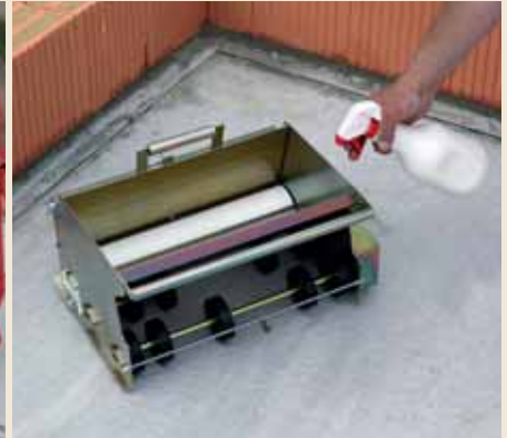
3.3 Die Mörtelrolle vor der ersten Befüllung dünn mit Trennmittel einsprühen. Das erleichtert die spätere Reinigung.
