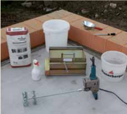
3.1 Benötigtes Material (gem. Wienerberger Produktprogramm): Dünnbettmörtel, Reinigungsspray (Trennmittel), Anrührreimer, VD-Mörtelrolle, Wassereimer, Doppel-Rührquirl, Schöpfkelle, Feile.
