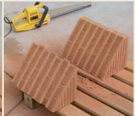
8.12 Schräg trocken geschnittener Ziegel.
