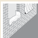
Abdeckung der Fensterbrüstung oder provisorischer Verschluss der Öffnungen mit Folientafeln (mit Tropfnase)
