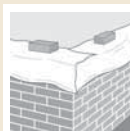
Folien-Abdeckung bei Arbeitsunterbrechung
